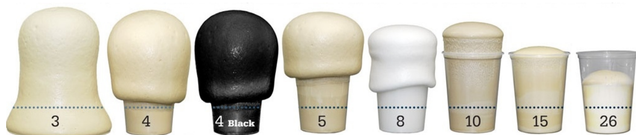
Ukázka napěnění 250 ml namíchané pěny v nádobě ca. 1 litr
